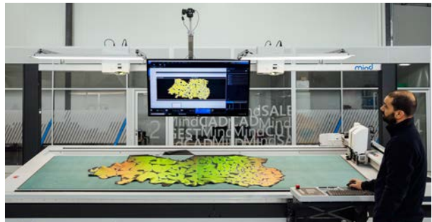
Erkennung von Fehlern und Projektion von Hilfslinien auf ein Stück Leder
