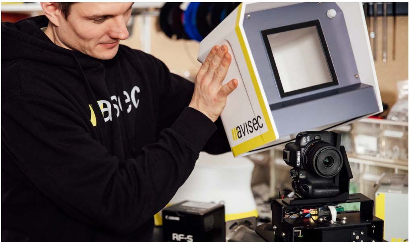
Servicetechniker Simon Fenner montiert ein wetterfestes Gehäuse an der Construction Camera Pro
